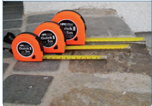
Abb. 44: Rollmaßband Länge von 2–8 m
