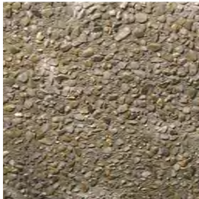
Abbildung 8: Waschbetonoberfläche mit heller Gesteinskörnung [Foto VÖZFI]
