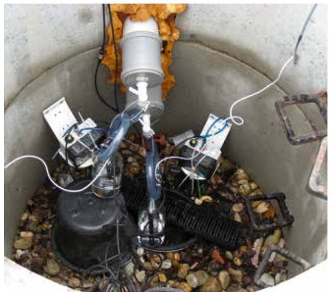
Messeinheit versickerungsfähige Wegebefestigungen
